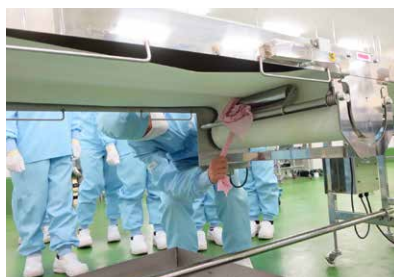
コンベアローラーへの巻き込まれ体験(味の素冷凍食品(株))
