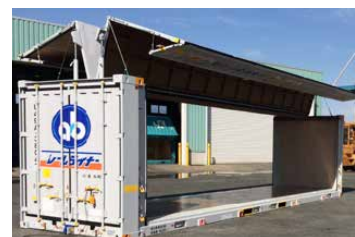
鉄道輸送用31ftコンテナ「レールライナー」®。ウィング側面一体構造(折曲式フルウィング)で、側面をすべて開放できスピーディに荷役作業が行える
