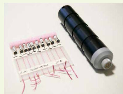
ピンガー(超音波標識)と受信機
