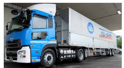
専用トレーラー「リレーライナー ® 」 パレット積載量も従来の大型トラックの1.5倍 (16枚⇒24枚(床面積))
